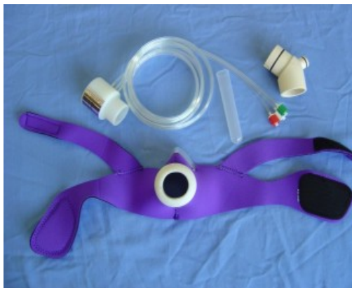
Figura 5: Máscara de neoprene, tubo coletor de saliva, pneumotacógrafo e adaptador utilizados durante a análise de trocas gasosas.
