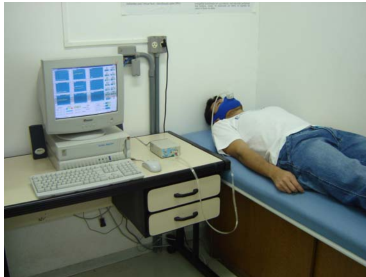
Figura 4: Indivíduo durante a análise de trocas gasosas em repouso, o equipamento VO2000 (INBRASPORT®) e o software AEROGRAF®.
